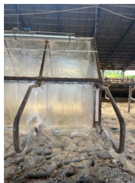
Billede 1 Her ses opbygning af metanhusene med hhv. plastlameller, jernramme og plader af transparent polycarbonat.
