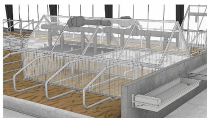
Figur 6 Metanhuset placeret ved den dobbelte sengbaserække ses her fra den ene gavl (den anden gavl består af en vaskevæg af beton) og fra en af de to længdesider, hvor der er fire tilgængelige sengebåse fra hver side, i alt otte sengebåse.
