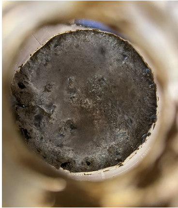
Figur 5: Billede taget af overfladen af gylle i flasken med svovlsyre-behandling ved forsøgsafslutning.
