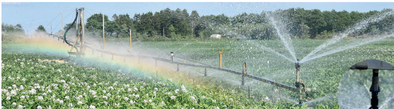
Ovenfor ses en vandingsbom fra Rosenkvist. Bommens bredde er 54 m og den spreder yderligere 9 m til hver side, dvs. dens arbejdsbredde er ca. 72 m. Foto: Gunnar Schmidt, Byggeri & Teknik A/S.
