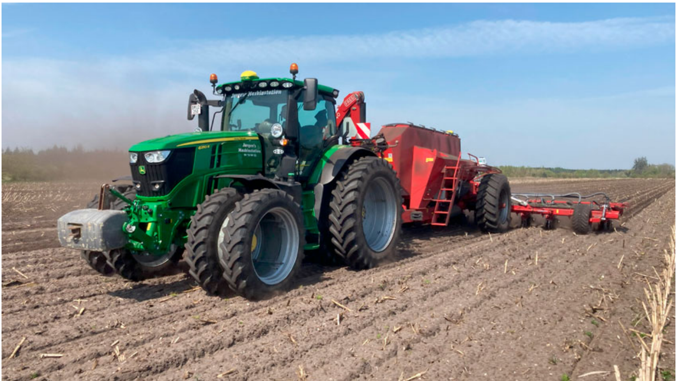
Billede 3. Billedet viser et eksempel på korrekt hjulmontering ved såning af majs på både traktor og såmaskine. Hjulene er monteret, så der ikke sås i hjulsporene. Med en rækkeafstand på 75 cm skal sporvidden mellem de inderste hjul være 1,5 meter. Sporvidden mellem de yderste hjul skal være 3,0 meter. Afstandene er fra midthjul til midthjul. Foto: Martin Mikkelsen, SEGES Innovation.
