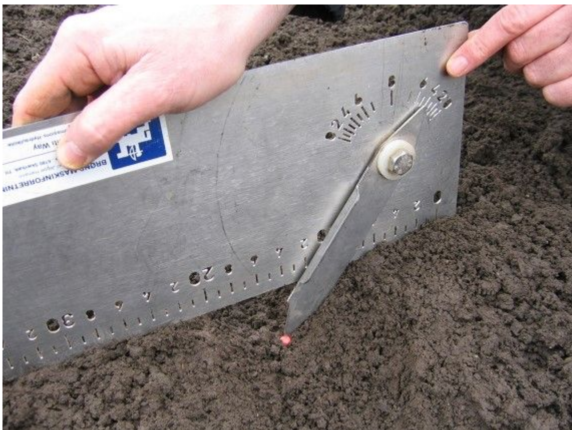
Billede 2: Billede 1 og 2, Tjek frøafstand og sådybde efter alle såhuse flere gange under såningen. Amazone har udviklet en handy plade (billederne), der kan skrabe jorden væk over frøene i såsporet, og måle frøafstanden og måle sådybden. Pladen kan købes hos Brøns Maskinforretning ApS i Skærbæk tlf.: 74753112
